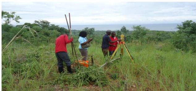
Fig 4: Demarcação usando teodolito (Metangula, 2016)
